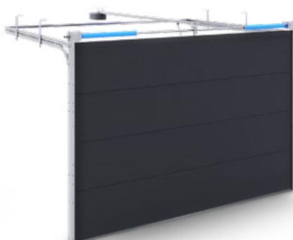
Il sistema di molle a torsione è consigliato per portoni di grandi dimensioni, sollevano infatti un carico maggiore rispetto alle molle a trazione. L'installazione di portoni sezionali con molle a torsione nella parte anteriore è possibile se l'altezza dell'architrave è di almeno 200 mm. La capacità di carico massima di sollevamento è di 195 kg.
