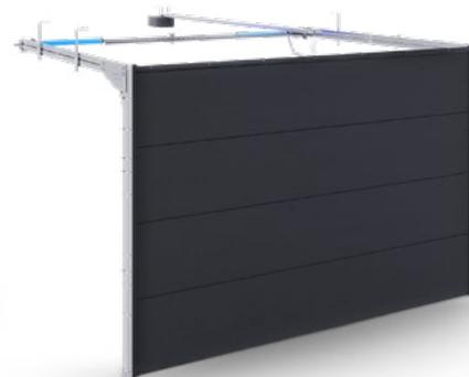
La posizione delle molle di torsione nella parte posteriore ne consente il montaggio in un vano con architrave con altezza minima di 85 mm (115mm in caso di portone motorizzato). La capacità di carico massima è di 195 kg.
