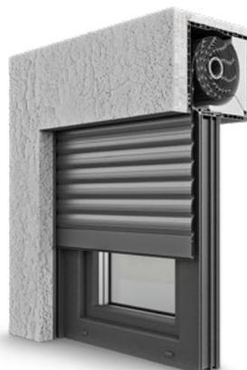
Soluzione per i clienti più esigenti, questo sistema è caratterizzato da un elevato isolamento termico grazie alla coibentazione supplementare del cassonetto. Opoterm garantisce anche parametri statici elevati che ne rendono possibile l'utilizzo su grandi superfici. Le zanzariere possono essere inserite all'interno del cassonetto stesso.
