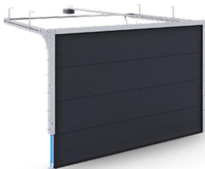
Consigliato per l'installazione in piccoli garage, in questo sistema il peso dei pannelli è bilanciato da molle di trazione montate lungo le guide verticali. L'installazione è estremamente veloce e facile e non richiede particolari avvolgimenti delle molle. Il meccanismo utilizzato è caratterizzato dalla tripla molla (cosiddetto "molla dentro molla"), che consente all'armatura di sopportare e sollevare portoni fino a 120 kg di peso.
