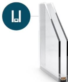
Soluzione standard per porte e finestre, la vetrocamera singola è composta da due vetri separati tra loro da un distanziatore ed ermeticamente sigillati. Lo spazio creato viene riempito principalmente da gas argon (90%) che riduce ulteriormente il coefficiente di scambio termico Ug.
