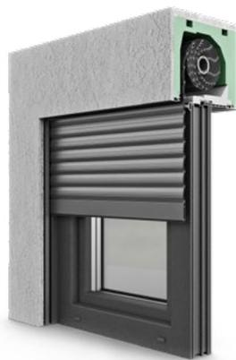
Il sistema ROKA-TOP è una soluzione tecnologicamente avanzata ideale per quasi tutte le finestre e utilizzabile sia negli edifici nuovi che in ristrutturazioni. Migliorato a livello di architrave, ha lo sportello di ispezione sul lato interno, garantendo la tenuta stagna di tutta la costruzione. Inoltre, il profilo in schiuma isolante aumenta l'isolamento termico evitando spiacevoli ponti termici.
